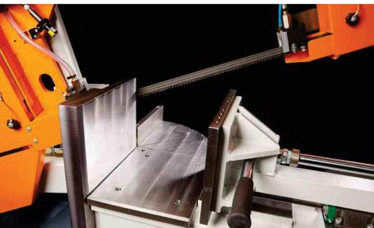
Materialspannung über mechanischen, lineargeführten Überfahrspannstock.
