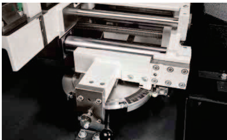
Vorschub über Kugelrollspindel, Gehrungseinstellung stufenlos.
