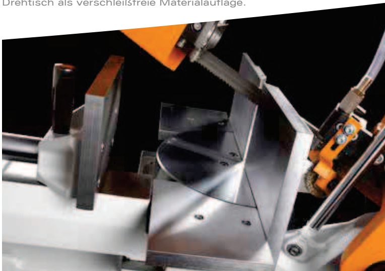
Drehtisch als verschleißfreie Materialauflage.
