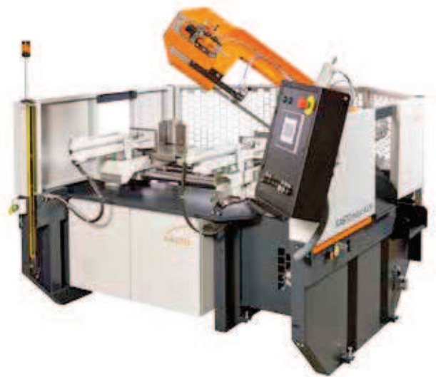
Gute Zugänglichkeit beim Sägebandwechsel.
