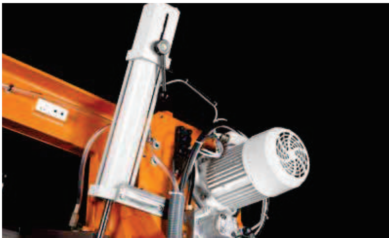
Stufenlose Schnittgeschwindigkeit über frequenzgeregelten Sägeantrieb.
